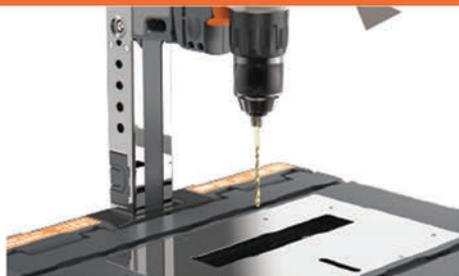
將壓桿 / 推杆插入立柱側面的 2 個拉桿孔，向下拉，將鑽頭往下壓。
