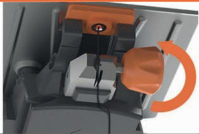
8 將線穿過兩個鋁塊間的縫隙，鎖緊螺絲旋鈕，將線固定在原位。
