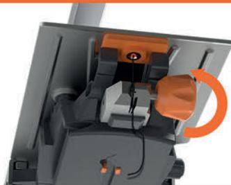
7 將切割穿過兩個鋁塊之間的縫隙，轉動旋鈕，鎖緊螺絲。
