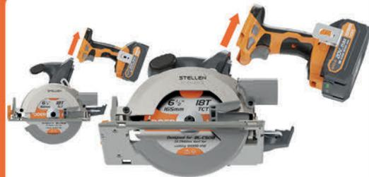
1 將電池手柄和電池從圓鋸拆下。
