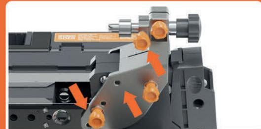
6 將螺釘插入支架側孔並鎖緊。
