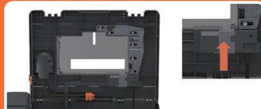
2 滑開鋸子支撐滑塊，將電路連接插頭插入定位。
