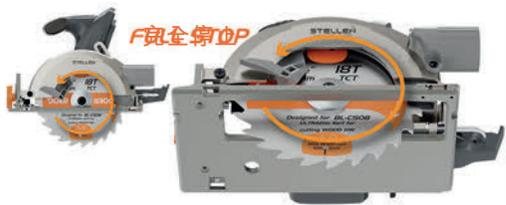
3 將彈簧式圓鋸防護罩拉到底，直到它完全縮回、停止。
