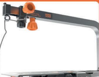
5 轉動輪子，拉出切割線，直到線長到足以穿過洞孔。
