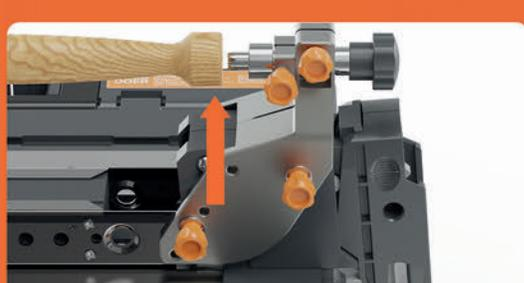
**8** 逆時鐘方向旋轉旋鈕，鬆開支架銷，將木片推出。
