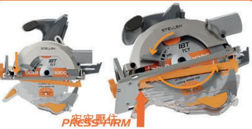
5 握住桌鋸防護罩 (刀盾) 支架前端，將後端推入圓鋸底板後側狹槽。
