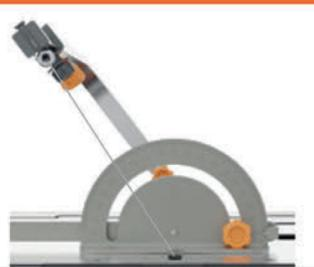
5 顯示如何使用量角器測量切割角度的圖片。
