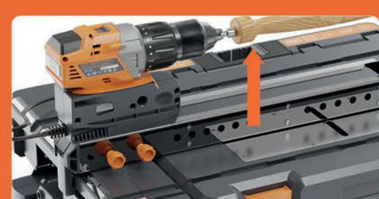
**7** 用螺絲鎖緊木件尾端，用鑷夾頭夾住螺絲尾端。
