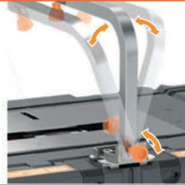
4 鬆開螺絲旋鈕，讓 L 管可以自由移動，以改變切割角度。
