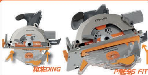
6 握緊前端，將桌鋸防護罩 (刀盾) 後端往下壓直到它牢牢固定。
