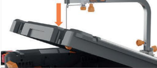
7 將切割線穿過熱線切割器底座的小孔。
